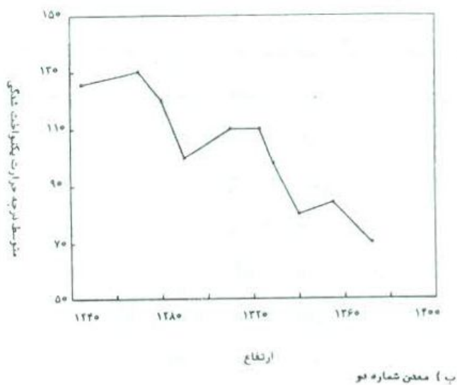
شکل ۵ نمودار تغییرات دماهای متوسط یکنواخت شدگی سیالات درگیر نسبت به ارتفاع.
