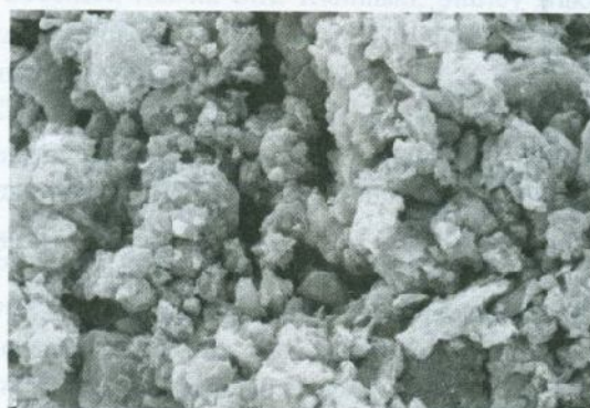
شکل ۵ الف) تصویر SEM زئولیت X، ب) VOX، پ) [VO(salen)X] (با بزرگنمایی ۳۰۰۰).
