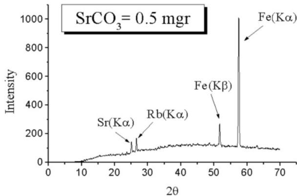
شکل ۲ اثر افزودن  $0.5 \text{ mgr}$  کربنات استرانسیوم بر طیف XRF نمونه استاندارد ۳۷
