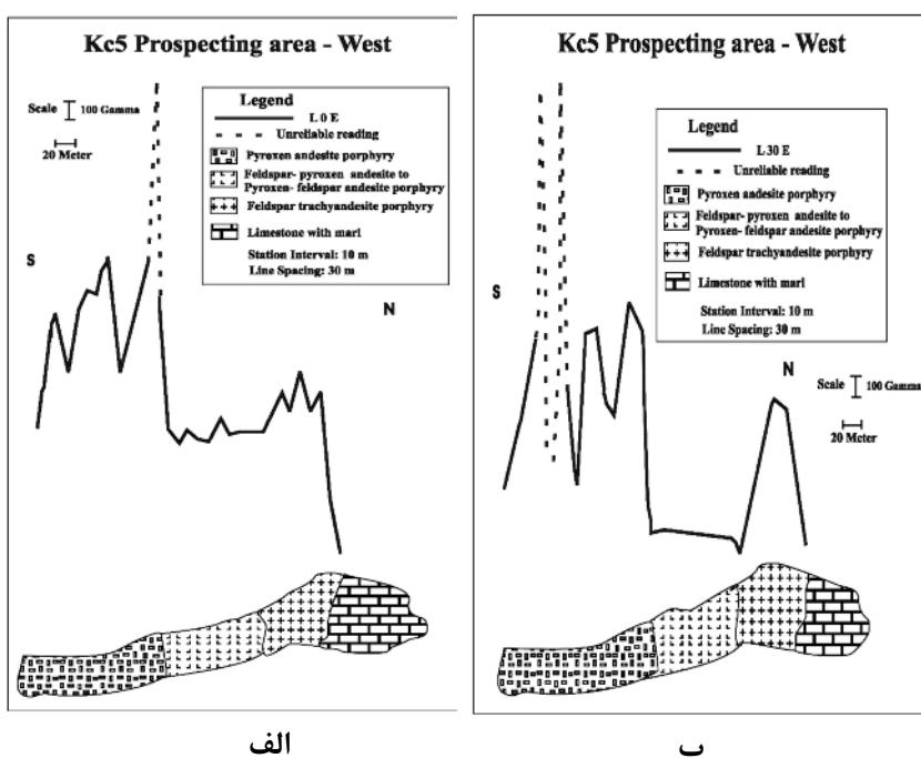
شکل ۵ (الف) نیمرخ شدت میدان مغناطیسی KC5 در L0E غربی و واحدهای سنگی تفسیر شده زیر پوشش آن. (ب) نیمرخ شدت میدان مغناطیسی KC5 در L30E غربی و واحدهای سنگی تفسیر شده زیر پوشش آن [۸].
