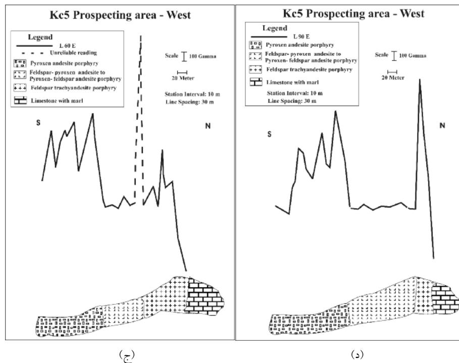
شکل ۵ ج) نیمرخ شدت میدان مغناطیسی KC5 غربی و واحدهای سنگی تفسیر شده زیر پوشش آن. د) نیمرخ شدت میدان مغناطیسی KC5 غربی و واحدهای سنگی تفسیر شده زیر پوشش آن [۸].
