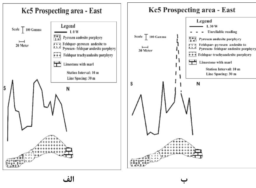
شکل ۶ (الف) نیمرخ شدت میدان مغناطیسی L0W در KC5 شرقی و واحدهای سنگی تفسیر شده زیر پوشش آن. (ب) نیمرخ شدت میدان مغناطیسی L30W در KC5 شرقی و واحدهای سنگی تفسیر شده زیر پوشش آن [۸].
