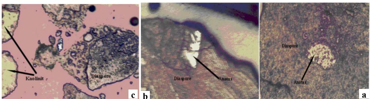
لوح ۲ تصاویر میکروسکوپی مقاطع صیقلی، نمونه‌ای از کانی آناتاز و چگونگی درگیری آن با دیگر کانیها ( $100\times$ ). a: قطعه پیزولیتی بزرگ را که کانی آناتاز در هسته آن قرار گرفته است. b: قطعه کوچک آناتاز به صورت درگیر با کانی دیاسپور. c: قطعات آزاد کانی دیاسپور و کائولینیت در ابعاد نسبتاً درشت.
