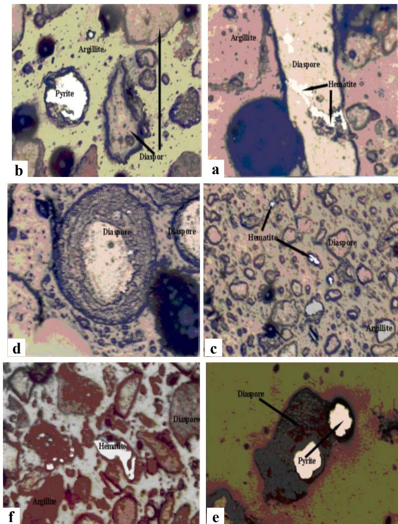
لوح ۳ تصاویر میکروسکوپی مقاطع صیقلی، نمونه‌ای از کانی‌های کانسار بوکسیت دوپلان ( $100\times$ ). a: قطعه‌ای از دیاسپور که در آن رگه‌های میکرونی هماتیت دیده می‌شوند. b: قطعه‌ای از پیریت که به صورت آزاد بین قطعات دیاسپور و آرژیلیت مشاهده می‌شوند. c: قطعات مختلف (از لحاظ اندازه) آرژیلیت و دیاسپور و هماتیت که در بافت برشی دیده می‌شود. d: پیزولیتی از دیاسپور. e: قطعات پیریت که به صورت درگیر با دیاسپور دیده می‌شوند. f: قطعه‌ای از کانی هماتیت که تقریباً به صورت آزاد بین قطعات دیاسپور قرار گرفته است.
