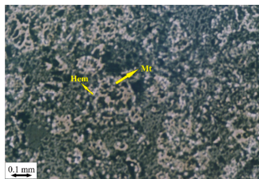
شکل ۸ جانمایی هماتیت در پیرامون مگنتیت، نور بازتابی و PPL.
