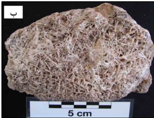
شکل ۱۳ نمونه‌های دستی مربوط به باریت. الف - بافت تیغه‌ای باریت همراه با بافت پوششی (Coating) منگنز، ب - بافت جعبه‌ای باریت.
