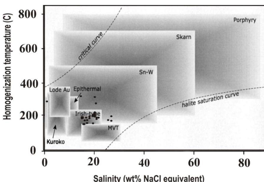
شکل ۸ تعیین نوع کانسار بر پایه درجه شوری و دمای همگن‌شدن فلوریت‌های کانسار کرمهدی بر روی نمودار (Wilkinson, 2001)، [۱۶].
