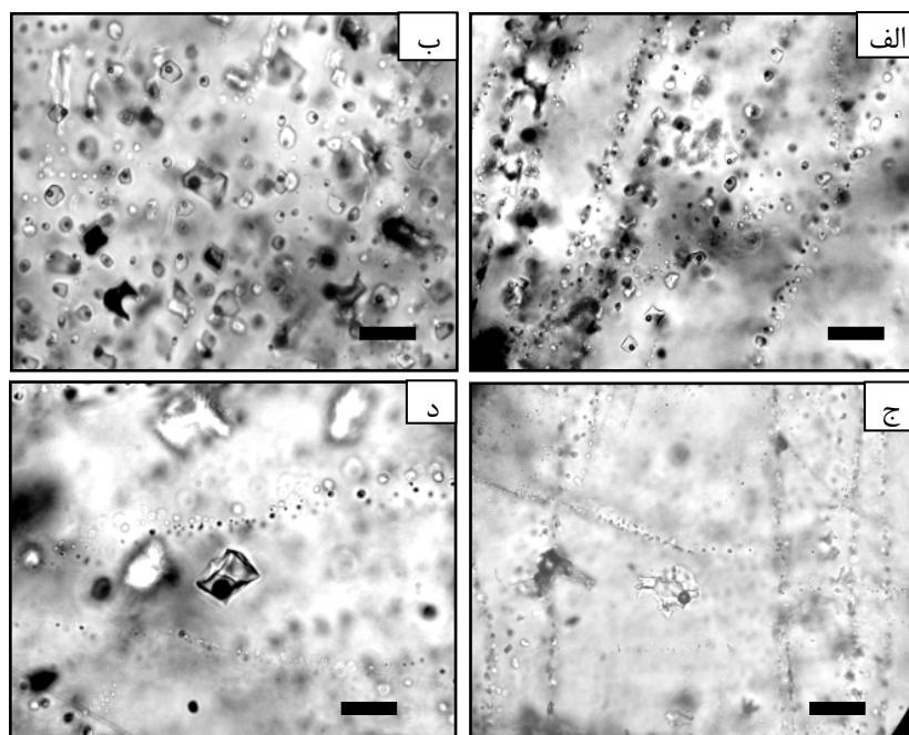
شکل ۵ تصویری از شاره‌های درگیر در نمونه‌های فلوریت کانسار کمرمه‌هدی (الف و ب): شاره‌های درگیر ثانویه در فلوریت رگه‌ای، (ج): شاره‌های درگیر اولیه در فلوریت درونزاد، (د): شاره‌های درگیر اولیه در فلوریت نشانگر ۲۰ میکرون است.
