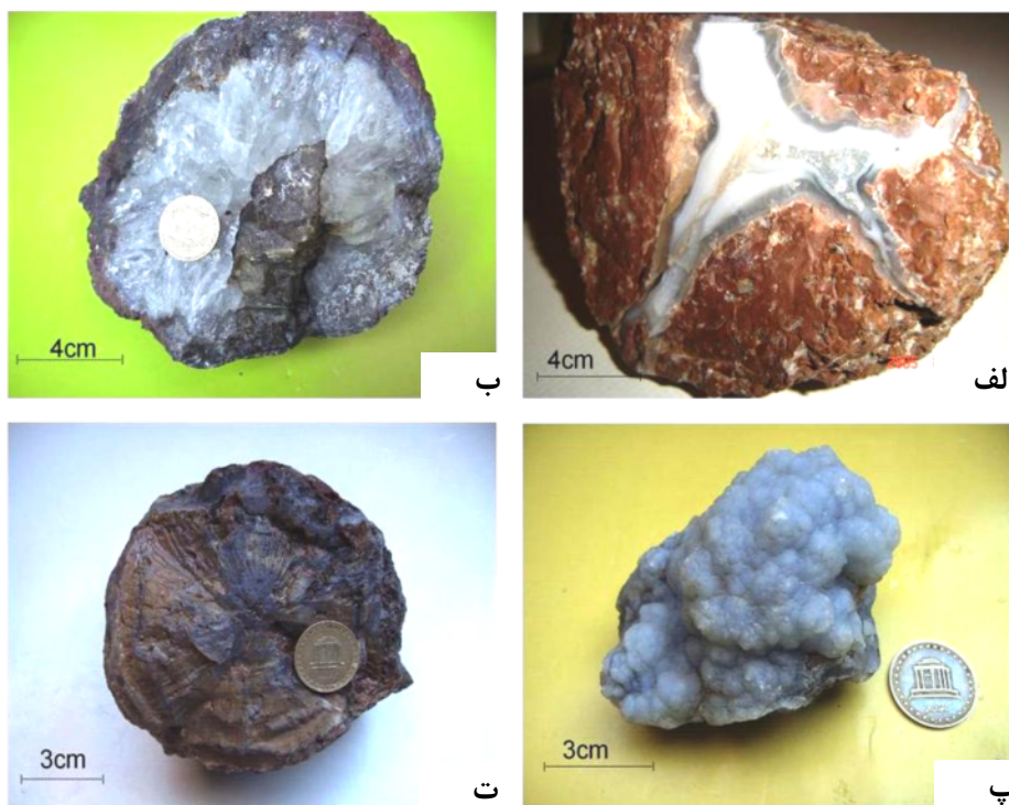
شکل ۳ ساختار (الف) ستاره‌ای. (ب) بلوردانی. (پ) گل‌کلمی. (ت) شعاعی و حلقوی.
