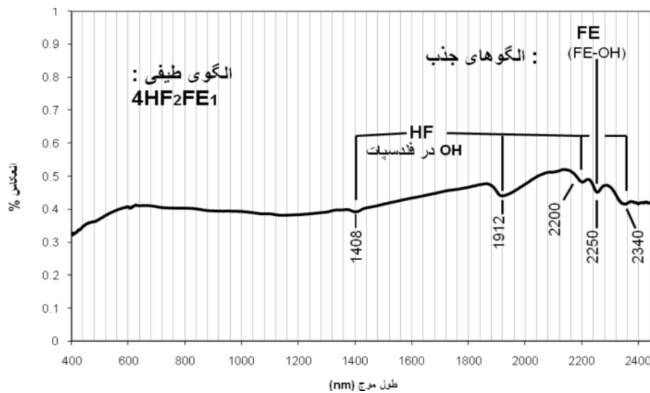
شکل ۵ طیف انعکاسی با الگوهای جذب، الگوی طیفی و فرایندهای جذبی موثر در شکل گیری الگوهای طیفی.
