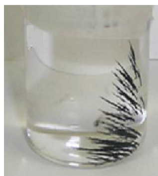
شکل ۳ منظم شدن نانوذرات کبالت پس از نزدیک شدن آهنربا به بشر.
