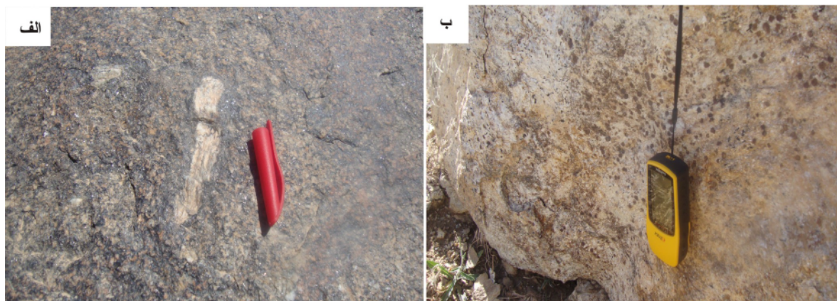
شکل ۲ تصاویر صحرایی واحدهای سنگی گارنت‌دار، (الف): تصویر صحرایی گرانودیوریت‌های گارنت و آندالوزیت‌دار که آندالوزیت به خوبی دیده می‌شود، (ب): تصویر صحرایی پگماتیت‌های گارنت‌دار.
