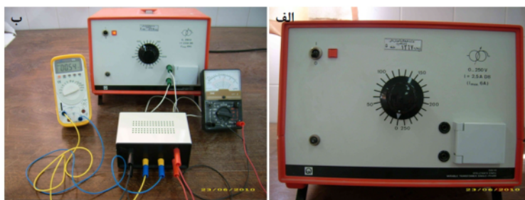
شکل ۵ الف. ترانسفورماتور کنترل کننده ولتاژ تزریقی. ب. مبدل جریان مستقیم و چگونگی ارتباط آن با ترانسفورماتور، ولت متر و آمپر متر.
