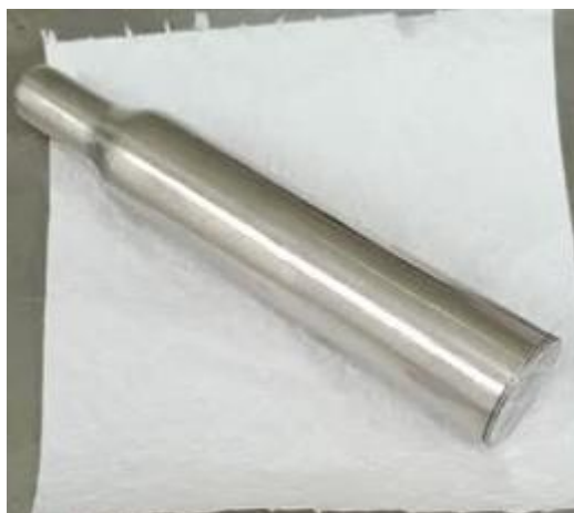
شکل ۱. بوتنه‌ی پلاتینی استفاده شده برای رشد تک‌بلور PIN-PMN-PT.
