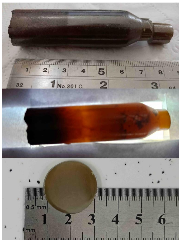
شکل ۵. تک بلور PIN-PMN-PT رشد داده شده با استفاده از روش بریجمن.
