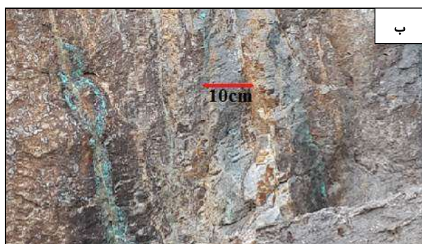
شکل ۶ کانی‌زایی مس در منطقه درخت سنجد: الف) کانی‌زایی آتاکامیت و کالکوسیت؛ ب) کانی‌زایی به صورت مس اکسیدی در راستای شکستگی‌ها.
