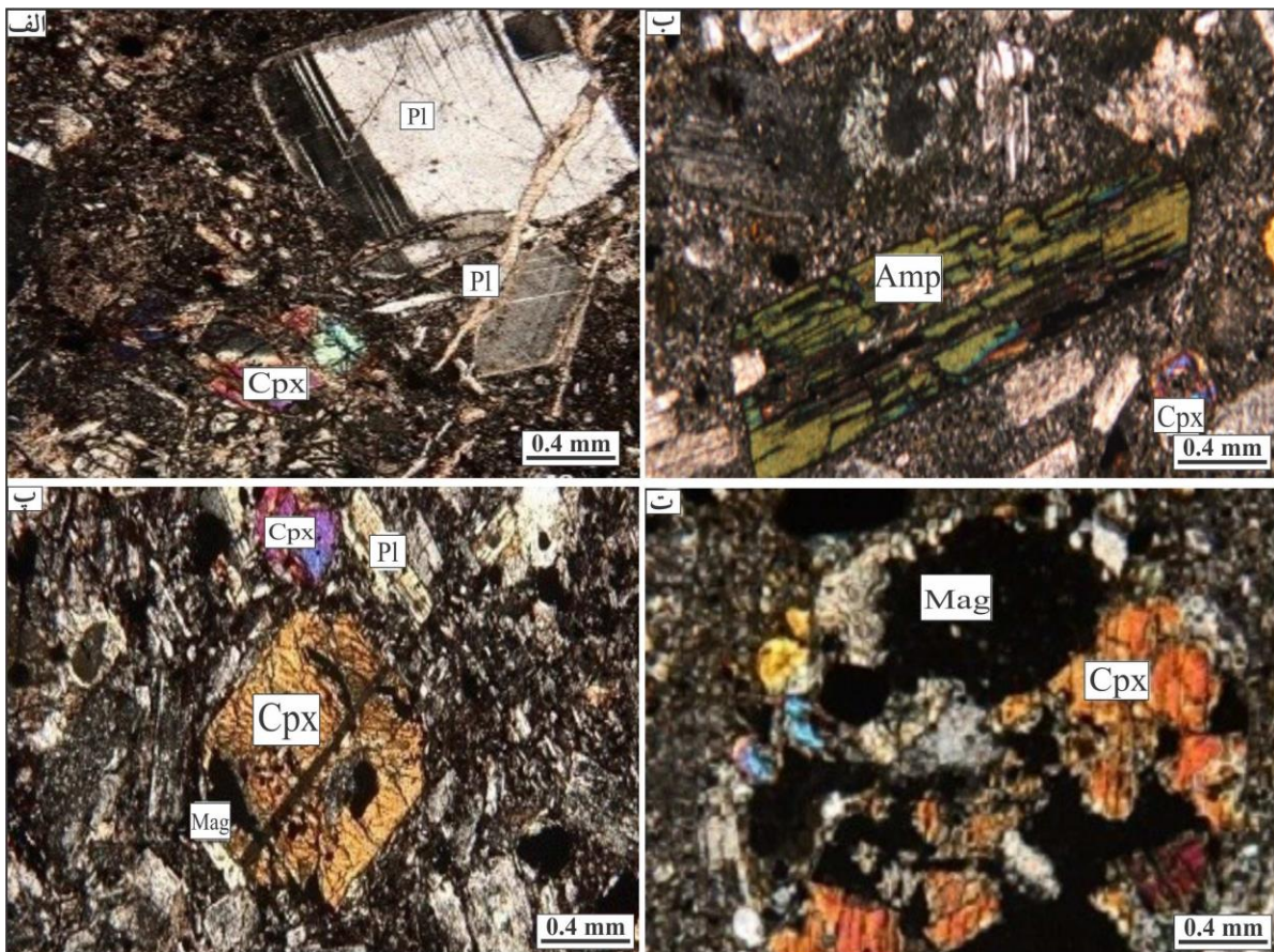
شکل ۴ تصاویر میکروسکوپی سنگ‌های آتشفشانی کوه بندسیاه در شمال غرب انارک: الف) درشت بلورهای پلاژیوکلاز با ماکل چندریختی در نور قطبیده متقاطع، (XPL)، ب) درشت بلور آمفیبول همراه با درشت بلورهای پلاژیوکلاز در زمینه ریزدانه (XPL)، پ و ت) درشت بلورهای کلینوپیروکسن که در برخی از نمونه‌ها دگرسان شده و کانی‌های کدر چون مگنتیت تشکیل شده‌اند (XPL). نشانه‌های اختصاری استفاده شده برای نامگذاری کانی‌ها برگرفته از ویتنی و اوانز [۲۱] هستند.
