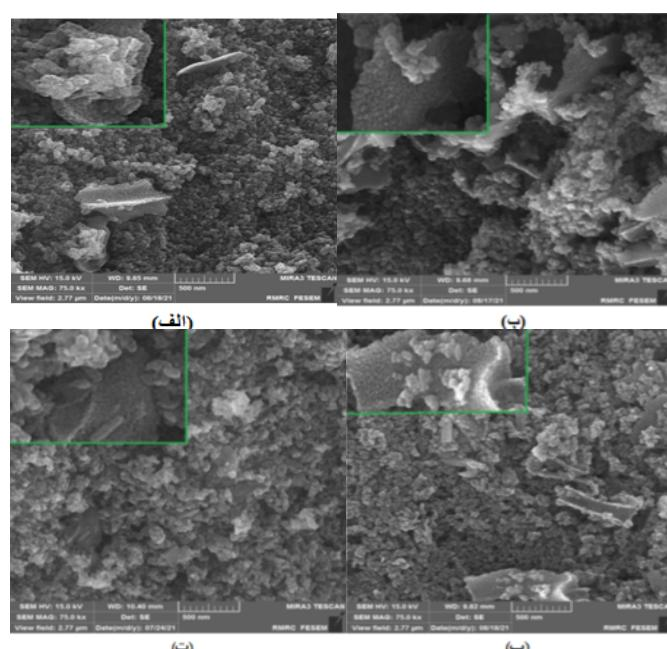
شکل ۱۱ نانوکامپوزیت های نانومیله های دی اکسید تیتانیوم اکسید گادولینیم با (الف) ۵٪، (ب) ۱۰٪، (پ) ۱۵٪ و (ت) ۲۰٪ تصاویر اکسید گادولینیم در مقیاس ۵۰۰ نانومتر.
