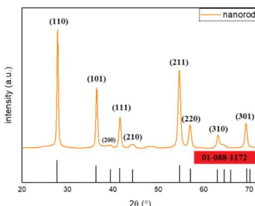
شکل ۱ الگوی پراش پرتوی ایکس نانومیله‌های دی‌اکسید تیتانیوم با فاز روتیل بهمراه شاخص‌های میلر کارت استاندارد JCPDS.
