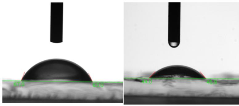
شکل ۱۲ (الف) زاویه تماس نانومیله دی‌اکسید تیتانیوم و (ب) اکسید گادولینیم.
