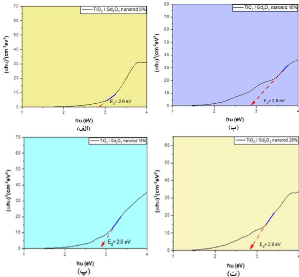
شکل ۱۷ نمودارهای تأک برای محاسبه گاف انرژی نانوکامپوزیت نانومیله‌های دی‌اکسید تیتانیوم با (الف) ۵٪، (ب) ۱۰٪، (پ) ۱۵٪ و (ت) ۲۰٪ اکسید گادولینیم.
