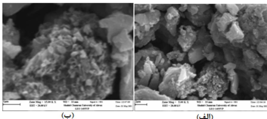
شکل ۸ تصاویر SEM pH ۵ نمونه دی اکسید تیتانیوم با ۲ در مقیاس‌های (الف) ۲ میکرومتر و (ب) ۱ میکرومتر.
