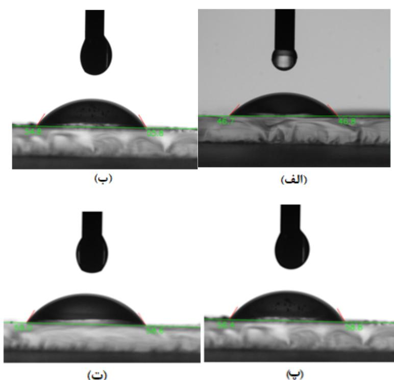
شکل ۱۳ زاویه تماس نانوکامپوزیت نانومیله‌های دی‌اکسید تیتانیوم با (الف) ۵٪، (ب) ۱۰٪، (پ) ۱۵٪ و (ت) ۲۰٪ اکسید گادولینیم.
