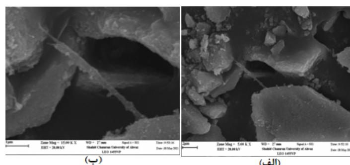
شکل ۹ تصاویر SEM pH ۱۱ نمونه دی اکسید تیتانیوم با ۱ در مقیاس‌های (الف) ۲ میکرومتر و (ب) ۱ میکرومتر.
