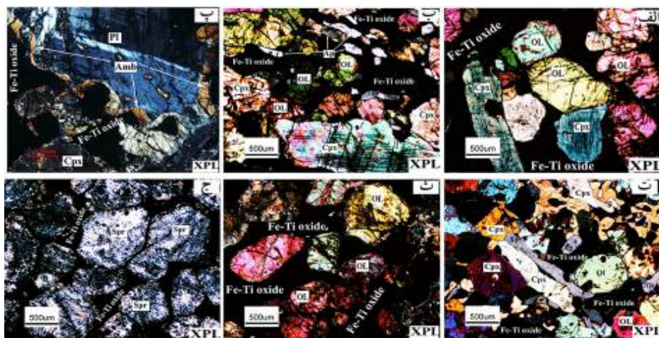
شکل ۳ تصاویر میکروسکوپی از انواع سنگ‌های فرامافیک GhMUС: الف) دونیت کانه‌زایی شده، ب) ورلیت آپاتیت‌دار کانه‌زایی شده، پ) نمونه مافیک کانه‌زایی شده همراه با لبه واکنشی از هورنبلند، ت) نمونه ورلیت آپاتیت‌دار کانی‌زایی شده، ث) نمونه دونیت کانه‌زایی شده، و ج) نمونه سرپانتینیت کانی‌زایی شده. Plg: پلاژیوکلاز، Hor: هورنبلند، Spl: اسپینل، Ol: الیوین، Opx: ارتوپیروکسن، Cpx: پروکسن [۱۶].
