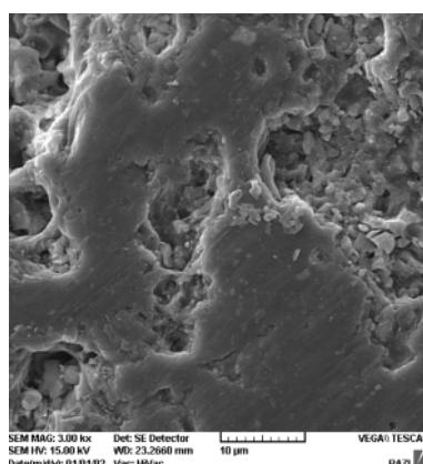
شکل ۶ تصویر SEM نمونه کلوخه سازی شده  $\text{SiC}$  در پردازندۀ ۸ درصد وزنی  $\text{Al}_2\text{O}_3$ .
