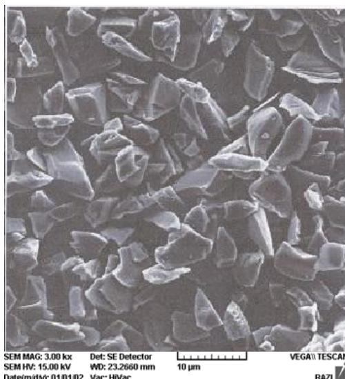
شکل ۱ تصویر SEM از پودر SiC- Al<sub>2</sub>O<sub>3</sub> از آسیاب شده.
