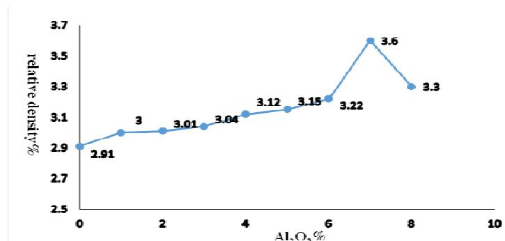
شکل ۳ چگالی نمونه‌ها نسبت به مقدار آلومینا.
