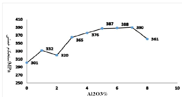
شکل ۷ استحکام خمثی نمونه‌ها نسبت به مقدار افزودنی Al<sub>2</sub>O<sub>3</sub>.
