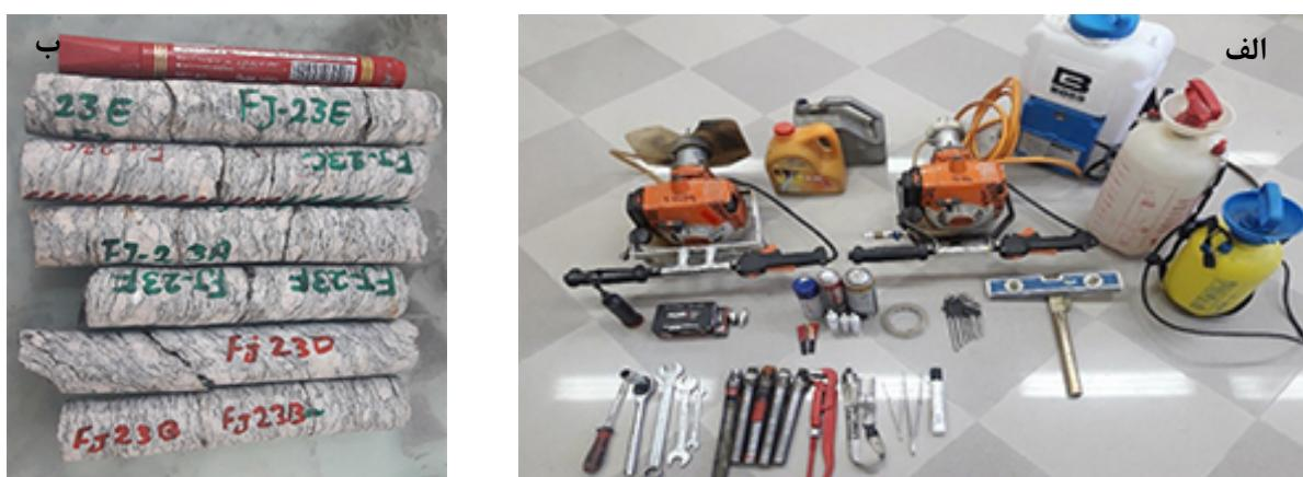
شکل ۶ الف) مجموعه وسایل مورد نیاز برای نمونه برداری (به روش مغزه‌گیری)، و ب) تصویری از چند عدد مغزه گرفته شده از گرانیت‌های بهشت دگر‌شکل شده چاه‌زد (سمت چپ).
