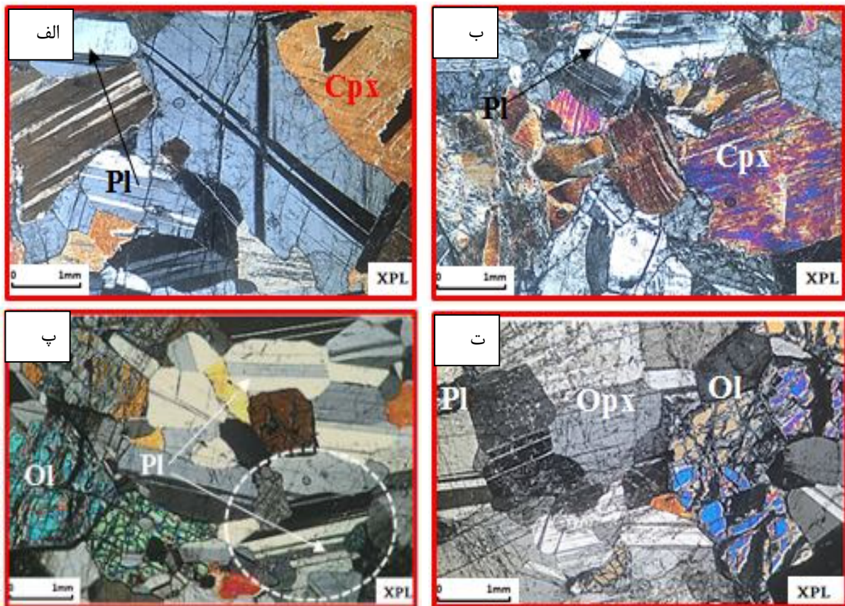
شکل ۹ تصاویری میکروسکوپی از گابروهای، مجموعه افیولیتی دشت سمسور: الف) پلاژیوکلاز (Pl) دانه درشت با ماکل چندریخت و کارلسباد، کلینوپیروکسن (Cpx)، ب) وجود پلاژیوکلاز (Pl) و کلینوپیروکسن (Cpx) که هر دو در حال دگرسان شدن هستند، پ) بلورهای سالم و دانه درشت پلاژیوکلاز (Pl) با ماکل چندریخت، کارلسباد و کانی دانه درشت اولیوین (Ol) در اولیوین گابرو، ت) کانی پلاژیوکلاز (Pl) به نسبت سالم، دارای ماکل چندریخت و کانی‌های اولیوین (Ol) و ارتوپیروکسن (Opx) در ترتولیت‌ها (همه تصاویر در نور قطبیده متقاطع (XPL) با بزرگ‌نمایی 40X تهیه شده‌اند).
