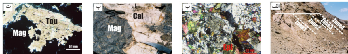
شکل ۳ الف) محل پهنه های کوارتز سینیت آتره شده و اپیدوت کوارتز در بین پهنه های معدنی و پهنه های کوارتز سینیت ب) اپیدوت جانشین شده با مگنتیت در پهنه های ۳. پ) جانشینی کلسیت به وسیله مگنتیت، ت) جانشینی تورمالین به وسیله مگنتیت در پهنه های ۴.
