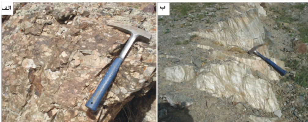
شکل ۲ الف) آگلومرا متشکل از قطعات ریولیت و داسیت به صورت میان‌لایه با متاولکانیتها و ب) سیرسیت شیسست دارای شیسست وارگی و نوارشکنجی. مقطع میکروسکوپی سیرسیت شیسست در شکل ۳ نشان داده شده است.
